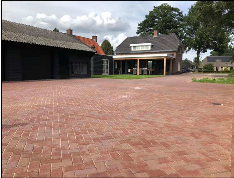
Figuur 35 Klinkerverharding in natuurlijke kleurstelling (herfsttinten)
